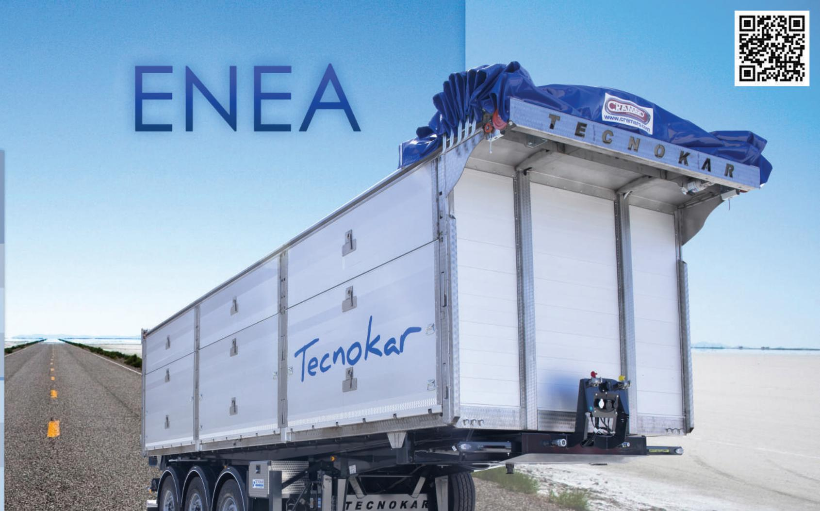
\* 3 assi fissi Mercedes, 6 pneumatici con cerchi in lega, spessore lamiera pianale 3 mm, no coperture.
